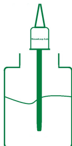
Plaats de temperatuur sensor in een vloeistof waar de temperatuur bekend van is.
