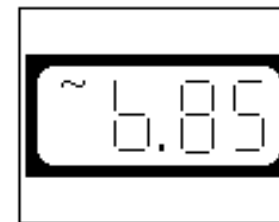
7. Zolang de meetwaarde knippert en het "~" teken in de display staat wordt de waarde gecontroleerd op stabiliteit.
